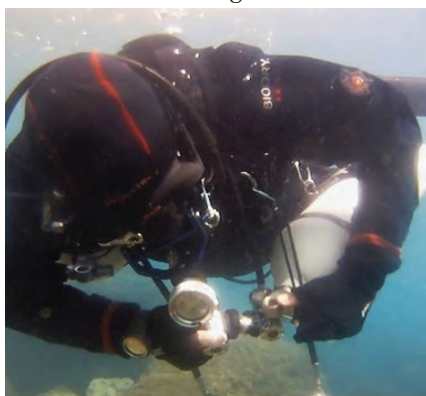
Figura 6.2 Quitar el regulador que no funciona de su botella y despejar la zona de la válvula para poder operar cómodamente.
