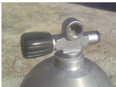
Figura 2.1 botella izquierda con conexión DIN
