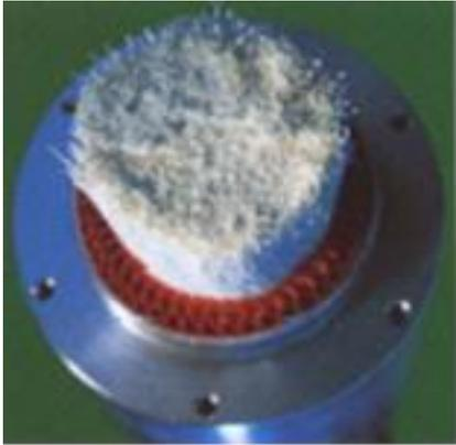
En una membrana hay miles de filamentos finos y huecos, en los cuales, debido a una diferencia de presión y las propiedades especiales de la membrana, las moléculas de oxígeno se difunden más rápidamente a través de las paredes de la membrana que las moléculas de nitrógeno.
