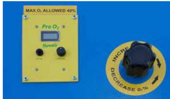
La cantidad que produce la membrana se controla mediante una válvula reductora sensible a la presión. El rendimiento preciso de estas válvulas permite producir Nitrox libre de peligro y con una desviación de menos de 0,1 % de la relación nitrógeno / oxígeno deseada.
